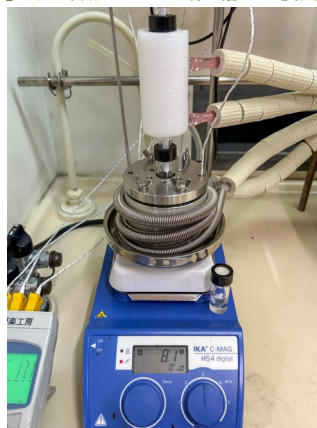
マイクロスケールCSTR ® 本体 材質:トカーペイトTK11 型式:溝型
