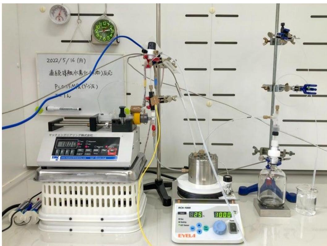
連続フロー合成(密閉/加圧)の例
