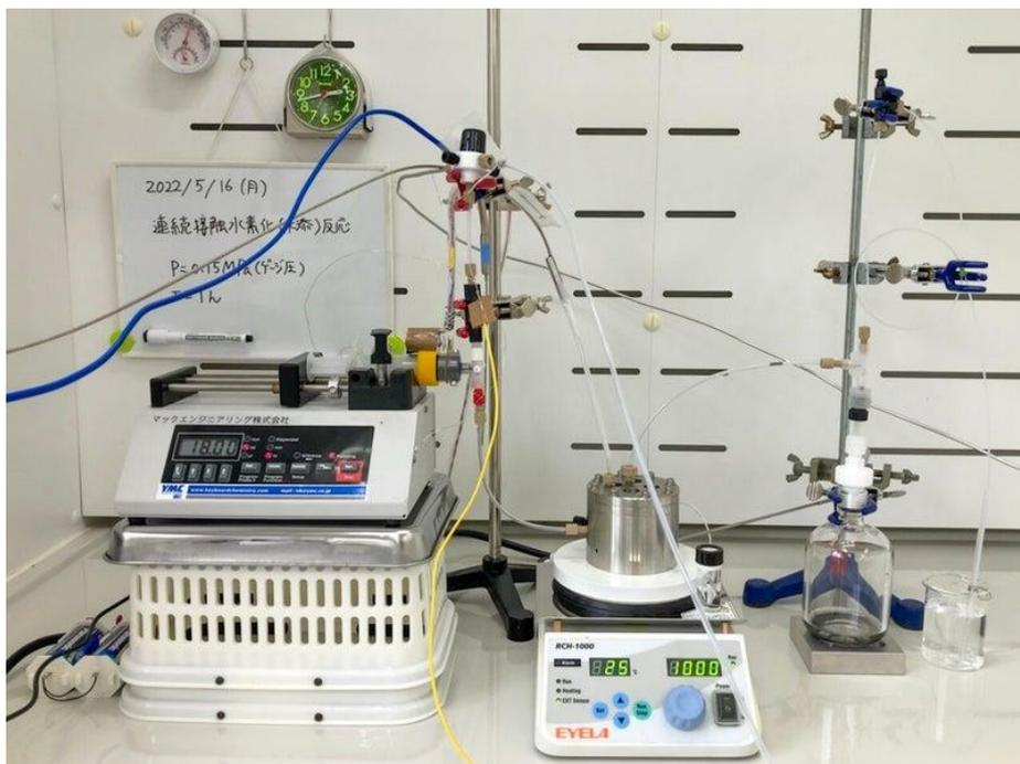
装置全体のイメージ(除: 温度記録計、窒素および水素ボンベ)
