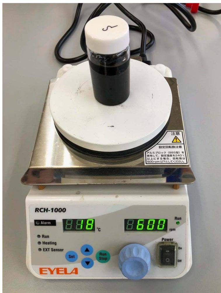
原料液の攪拌(混合・分散)
