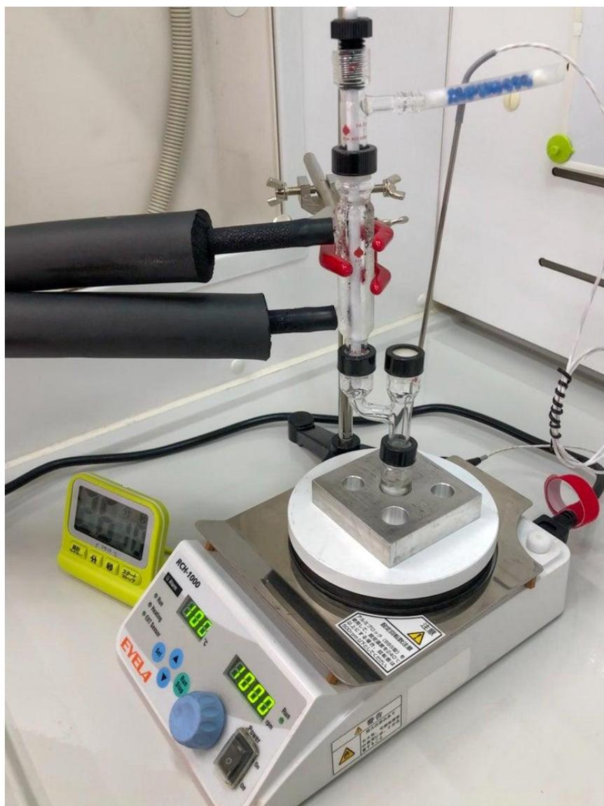
バッチ式エステル交換反応の様子（マイクロスケール有機合成キット使用）
