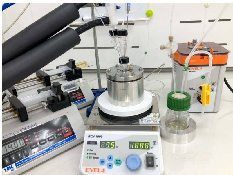
連続(フロー式)エステル交換反応の様子
